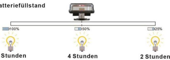
Der Batteriefüllstand ist eine Indikation und ist abhängig von Einsatzverhältnissen
